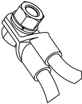
Рис. 8: вывод внешних катодных проводов 2x70 мм². Кабельные наконечники осажжены (11).
