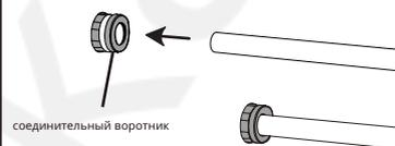
Чтобы отсоединить фитинг, нажмите на муфту соединителя в направлении горелки и оттяните шланг от горелки.
